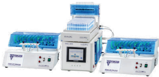
Sistema de Muestreo Automatizado de Celdas para Difusión Transdérmica
